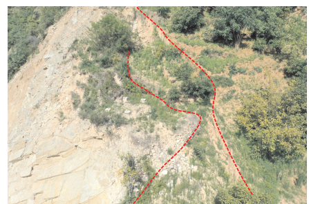
图7 后缘平台拉裂缝特征
