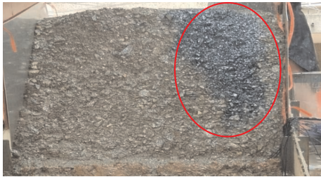
图 10 泼洒墨水测地表水流速
