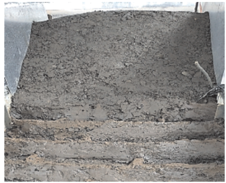
图 7 梯田区边坡试验模型
