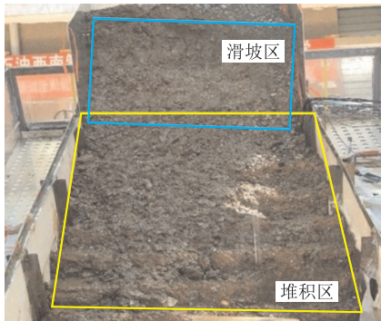
图15 工况二试验滑坡后状态
