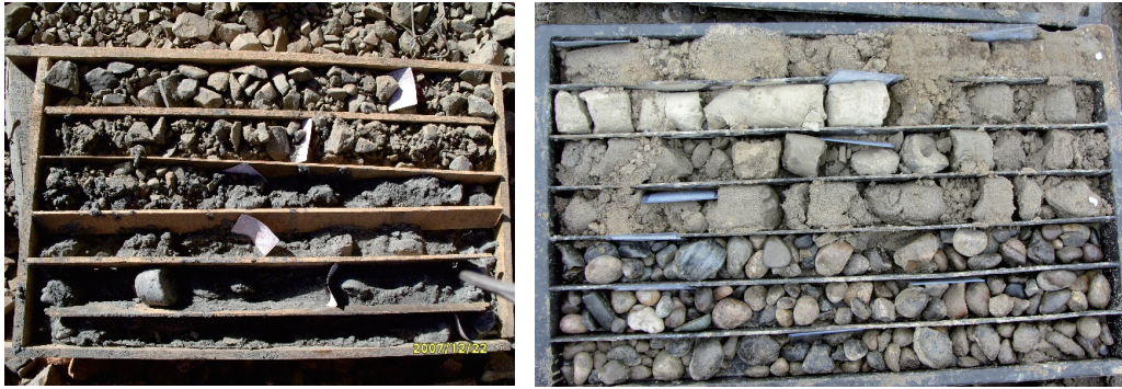
图3 多布水电站深厚覆盖层典型取芯照片
