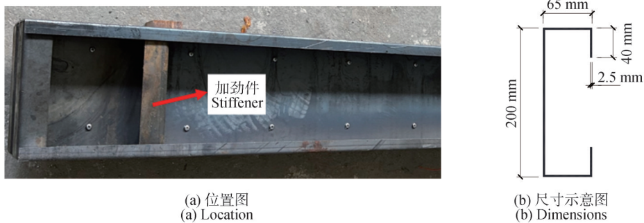
图3 加劲件位置及尺寸示意图
