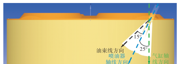
(b) 甲醇喷油器安装角度
