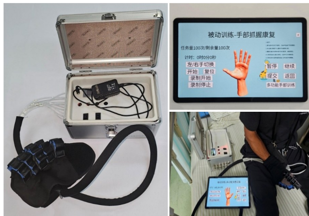
图1 仿蜂窝结构气动柔性手部康复机器人
