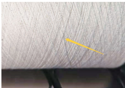
图2 经过槽筒表面碾压的纱头
