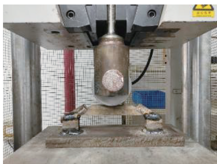
图 5 横梁的冲击试验装置
