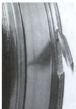
图 1 轴承套圈崩裂实例
