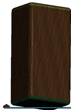
图 6 底面割袋过程仿真模型的网格划分
