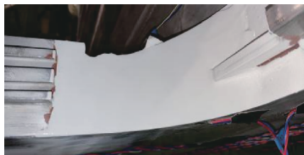
图4 试验方案 9 门角涂层体系静强度试验
