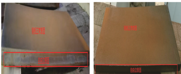
图4 8# 试板钢板表面锈蚀形成状态与自由边锈蚀形成状态对比
