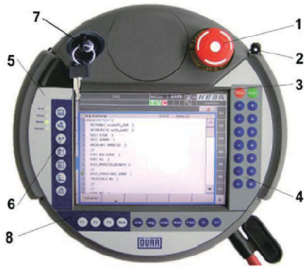
1 紧急停止按钮；2 用于触摸屏操作的勾选笔；3 状态显示区域；4 移动区；5 状态LED；6 功能块；7 钥匙开关；8 客户特别分配的按钮和功能键，用于控制机器人
