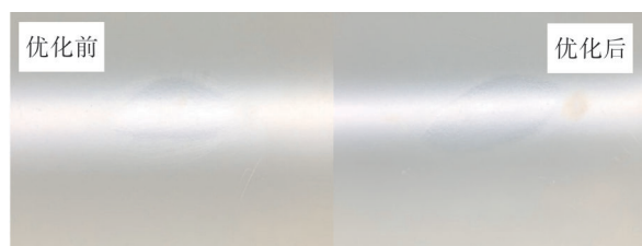
图4 薄膜工艺打磨方式优化前后对比
