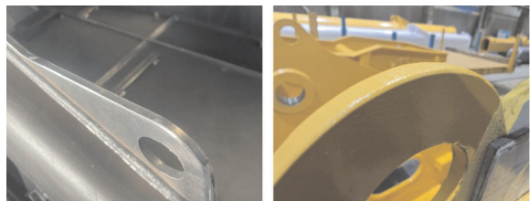
a.结构件尖锐楞边倒角 b.结构件尖锐楞边倒角后涂装
