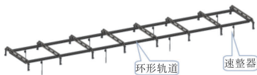
图 13 高处作业防坠落装置
