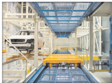
图4 多层 RGV 穿梭车立库
