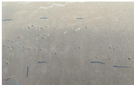
图1 TSA涂层表面典型起泡照片
