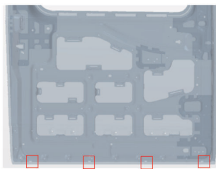
图 6 C 车型加开漏液孔后的侧拉门漏液模拟结果
