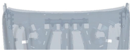
图 5 开启 5° 条件下的 A 车型引擎盖排气模拟结果
