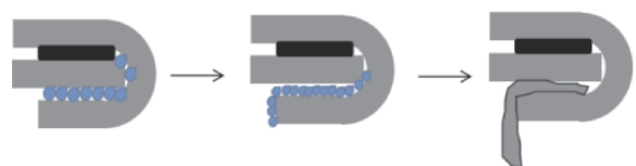
折边兜液 高温烘烤张力下降 烘烤固化形成流痕
