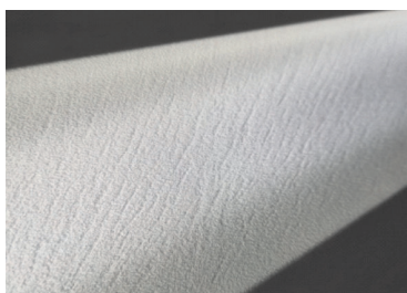
图 1 电镀锌预磷化板电泳条纹缺陷
