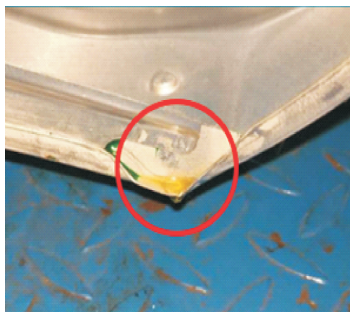
图3 零件底部边角有拉延油堆积
