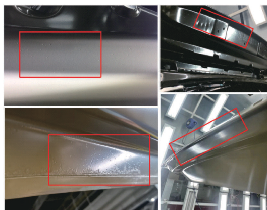
图 2 翻盖尾门及皮卡后栏板电泳气泡型缩孔状态
