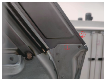
图4 窗框积液可能浸入途径
