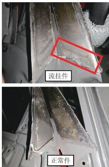
图2 右后门窗框流挂件与正常件解剖图
