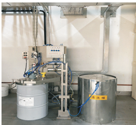
图 1 软管走珠式快速换色系统
