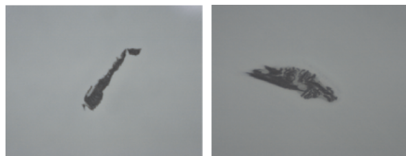
图4 支具漆片 50倍显微照片
