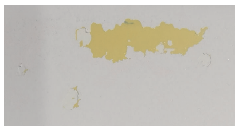
图 1 干胶带试验后漆层脱落
