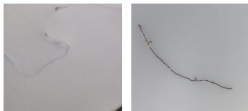
图 1 面漆外观纤维缺陷
