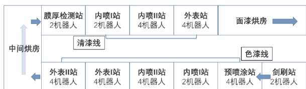
图 3 2010V 工艺面漆线布局
