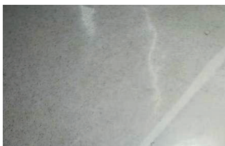
图 2 5# 试板打磨擦灰清洁度等级 V 级照片
