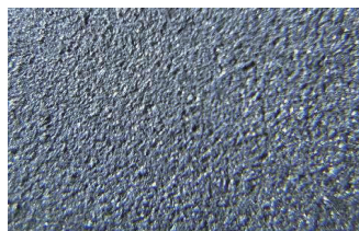
图 5 铝板喷砂粗糙度 22~31 μm 照片
