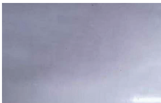
图 1 1# 试板喷砂粘灰清洁度等级 I 级照片
