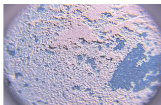
图 4 I 级清洁度拉拔分离面外貌(深色为基材)
