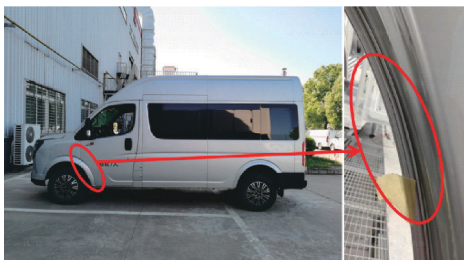
图1 左前车门包边 PVC 焊缝密封胶开裂
