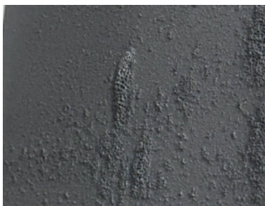
图1 电泳膜状态下出现的堆积型细小气泡
