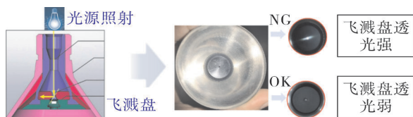
图 2 旋杯快速检查飞溅盘异常方法
