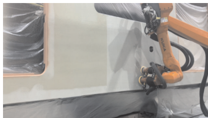
图 5 三磨头机构现车打磨过程
