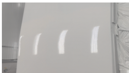
图 6 地铁车辆喷涂完面漆状态
