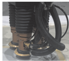
图3 改造后的多磨头打磨机构
