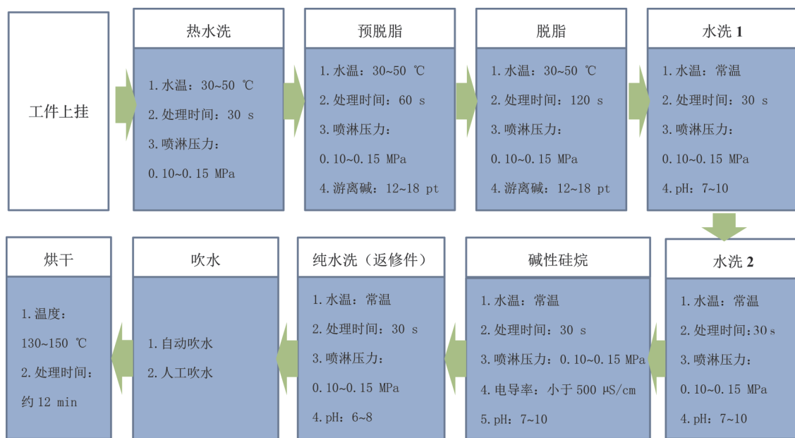
图 3 前处理免水洗碱性硅烷工艺流程及参数
