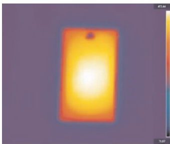
图 1 红外摄像机观察到的激光固化涂层
