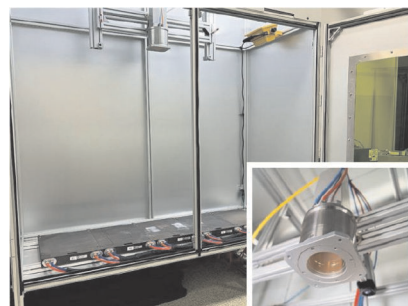
图 2 实验室用于粉末涂层固化工艺的激光加热器
