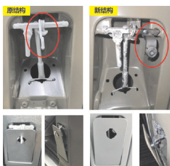
图 6 工装结构优化前后对比
