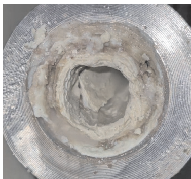
图2 被冰晶石严重堵塞的循环管路
