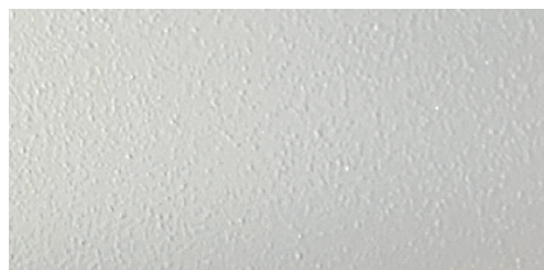
图1 车身外板的磷化渣形成的质量缺陷
