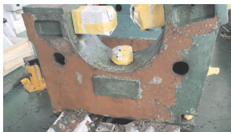
图2 局部面漆除漆后露出底漆层
