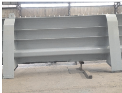
图9 车间涂装箱梁节段
