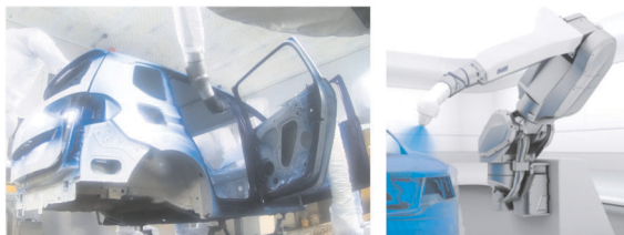
图4 机器人内喷和外表喷漆示意
