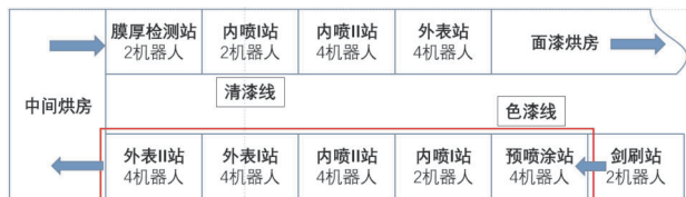
图3 面漆线工艺布局示意
