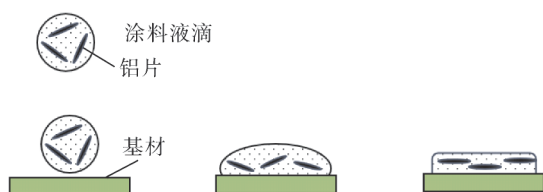
图4 涂料流动定向示意
