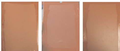
图 2 涂膜湿热老化试验照片
