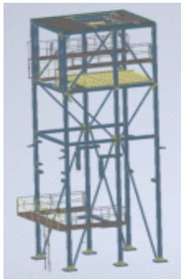
图 3 常规结构的超高出口塔
