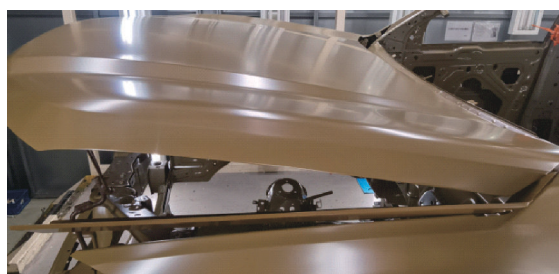
图5 翼子板引流工装安装示意
