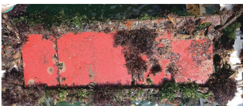
图9 螺旋桨抗空泡腐蚀防污涂料静态实海挂板2年照片
