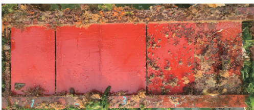
图8 螺旋桨抗空泡腐蚀防污涂料静态实海挂板1年照片
