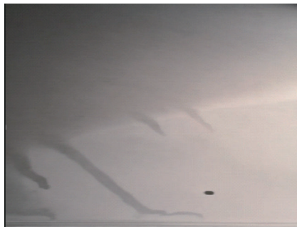
图 1 烘干炉内蒸气在极低温度的工件上凝结成水流
