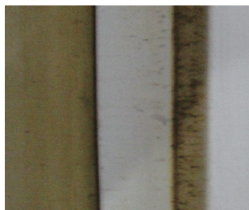
图 1 风沙较大环境 + 外轮廓结构有错台,造成喷砂面
