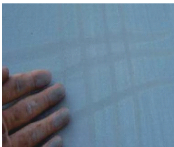
图4 涂层粉化失光(紫外线、酸雨)
