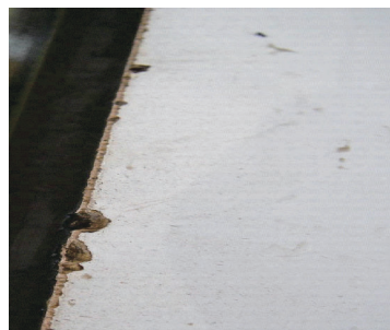
图 2 车窗边缘的侵蚀剥离
