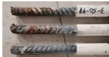
(b) RC-3-50-锈蚀 24 h 试件
