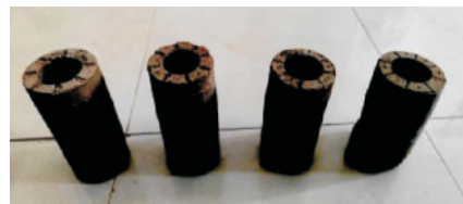
图3 不同挤压压力下的试件 Fig.3 samples under different extrusion pressures
